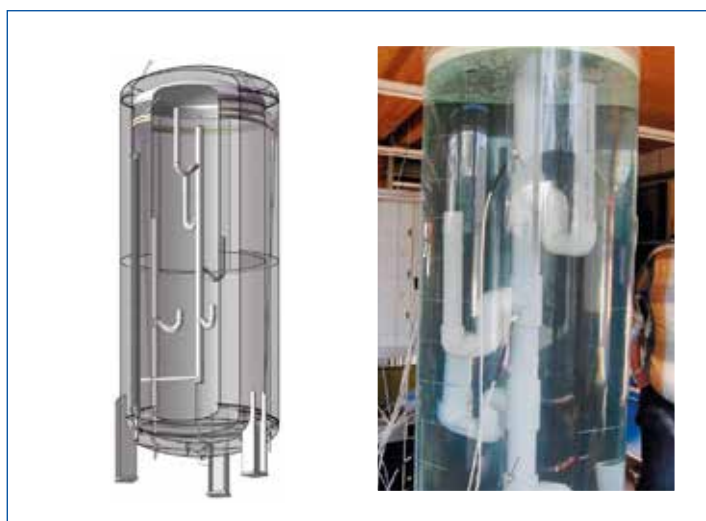
Pufferspeicher mit Schichtladeeinrichtung zum direkt beladen
